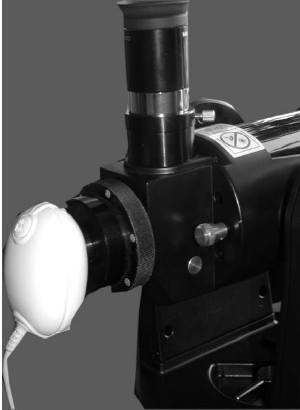
Abb. 5: Anschluss einer Webcam. Zenitnahe Objekte lassen sich so nicht fotografieren
