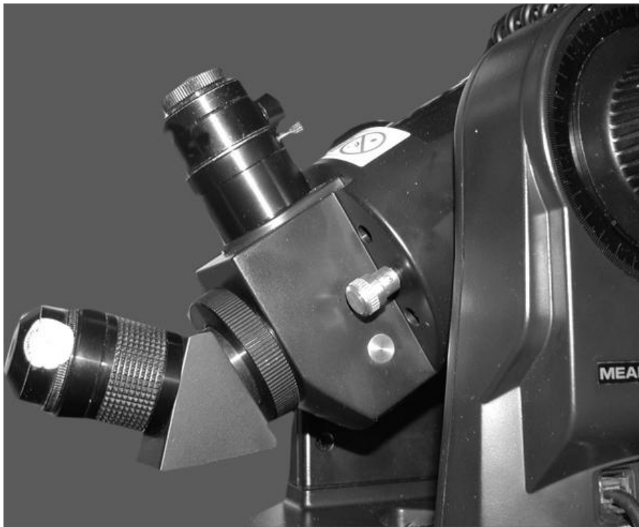
Abb. 3: 2 Einblicke am Okularende des ETX. Ein Spiegelkasten erlaubt das Beobachten in Zenitlagen. Beim getesteten Exemplar führten thermische Spannungen in der Spiegelhalterung aber einen starken Astigmatismus ein. Für terrestrische Objekte gibt es einen zweiten Einblick.
